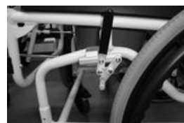
Photo. 11: Montage des freins sur le cadre.
