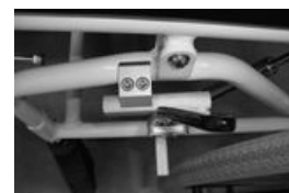
Photo. 12: Vérifiez que les freins sont fermement en contact avec le pneu.
