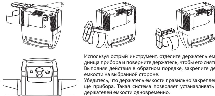
Используя острый инструмент, отделяйте держатель емкости от днища прибора и поверните держатель, чтобы его снять. Выполняя действия в обратном порядке, закрепите держатель емкости на выбранной стороне. Убедитесь, что держатель емкости правильно закреплен на днище прибора. Такая система позволяет устанавливать до двух держателей емкости одновременно.
